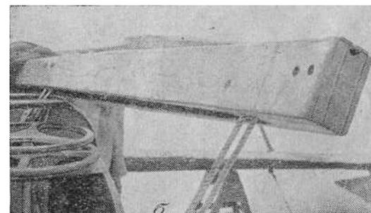
Рис. 24. Гик овальной (а) и прямоугольной (б) формы
