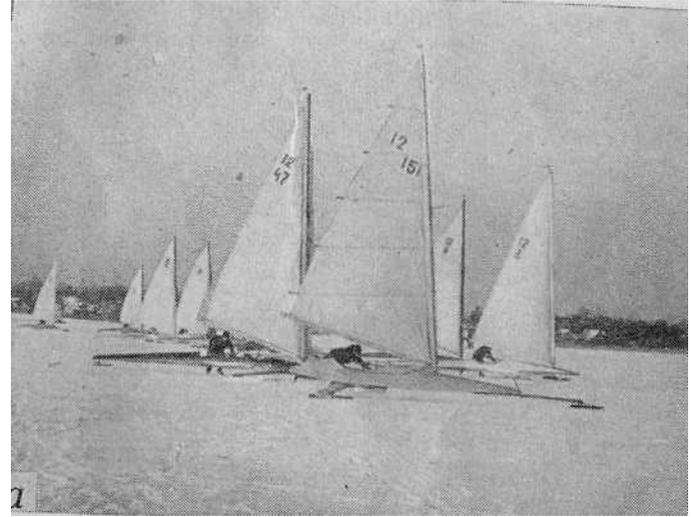
Рис. 21. Буер 12/151 с передним рулевым коньком (а); буер с передним рулевым коньком, управляемым румпелем (б)
