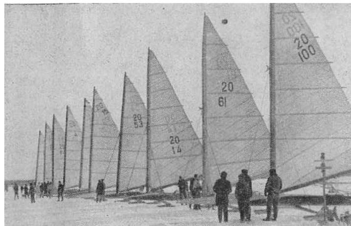
Рис. 22. Бермудский кэт — наиболее распространенное вооружение современных буеров
